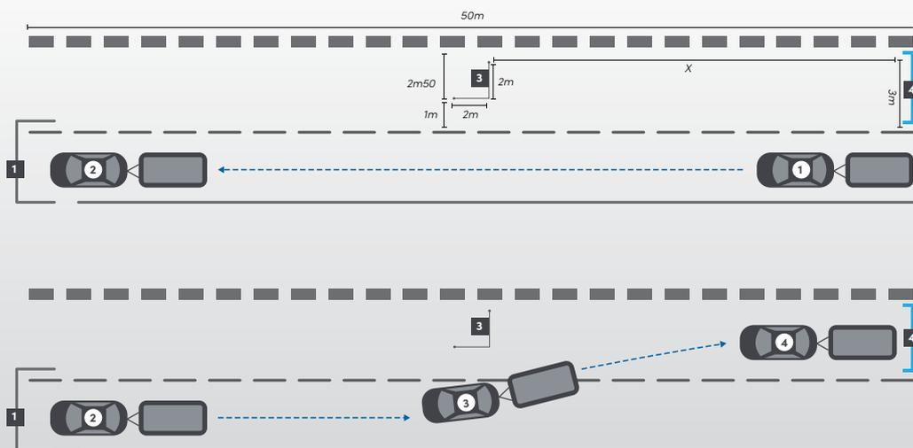
Distance entre la balise 3 et le quai 4 :  $X = 1,5 \times$  longueur train de véhicules plus distance de 2 à 5 m tirée au sort.
